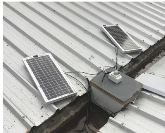
Instrumentation : 4 sondes thermocouples de type K et une sonde d'ensoleillement
